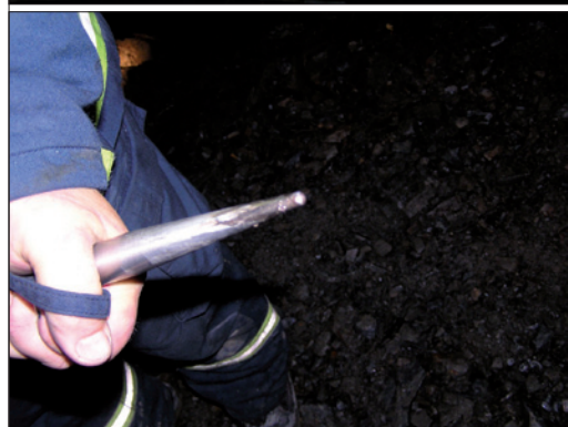
Obr. 1. Požár hotelu Odry způsobený úderem blesku do aktivního jímače ESE
