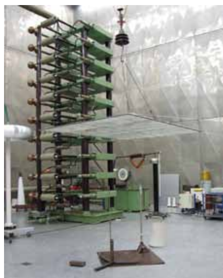
Experimentální porovnání konvenčního a aktivního hromosvodu v Laboratoři vysokých napětí na FEL ČVUT v Praze
